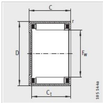
开式冲压外圈滚针轴
